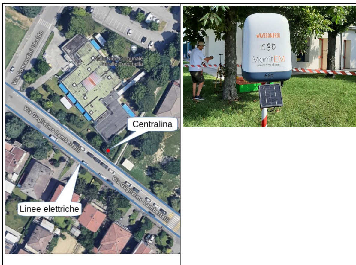
Figura 19 – Collocazione della centralina di monitoraggio delle linee elettriche MT all'interno dell'area cortilizia della scuola materna "Le Coccinelle" di Via Lambertelli – Forlì.
