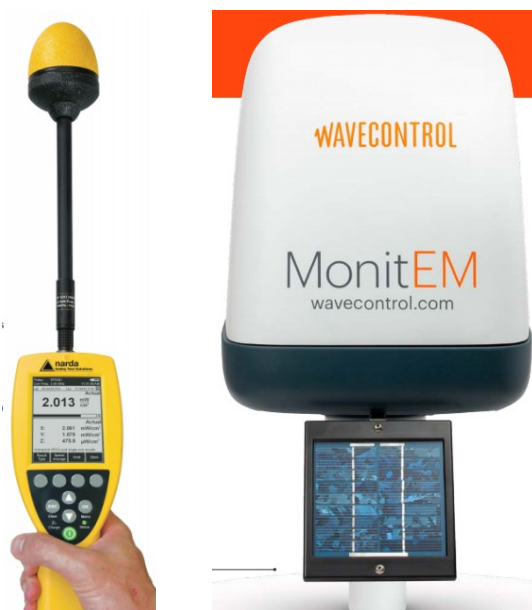
Figura 1 - Strumenti a banda larga: per misure di breve periodo e in continuo (centralina)
